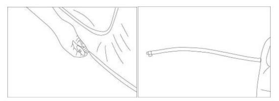
Ziehen Sie anschließend den auf der Innenseite befindlichen Kunststoffstopfen ab. Jetzt kann das Wasser herausfließen.
