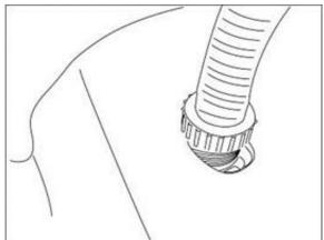
Öffnen Sie das Luftventil an der Whirlpool-Hülle und stecken Sie den Füllschlauch auf das Ventil.
