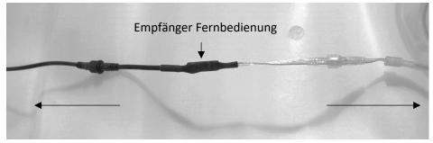
Links: schwarzer Anschluss zum Netzteil (2-poliger Stecker) Rechts: transparenter Anschluss zum Pool (4-poliger Stecker)
