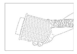
Setzen Sie die Filterkartuschenabdeckung auf die (neue) Filterkartusche und schrauben Sie die Filterkartusche durch Drehen im Uhrzeigersinn auf.
