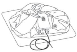
• Öffnen Sie den oben am Filter-Heizungselement des Whirlpools befindlichen Luftauslass und schrauben Sie den Füllschlauch auf.
