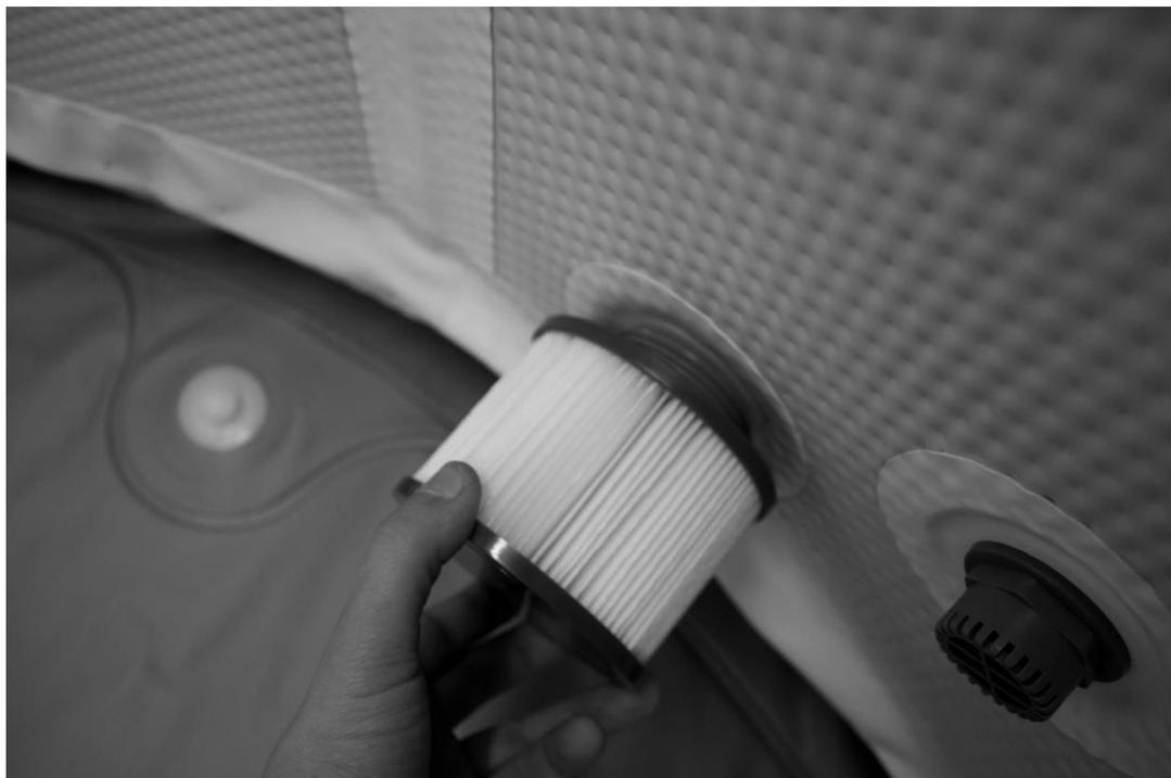
14. Fügen Sie die Filterschutzabdeckung auf die Filterpatrone auf.
