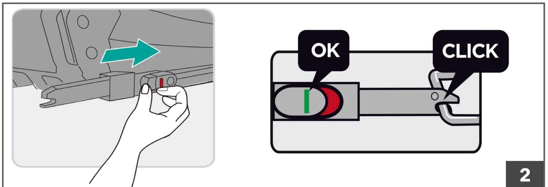
Tenez le siège de sécurité à deux mains et insérez fermement les deux bras ISOFIX dans les points d'ancrage ISOFIX du véhicule jusqu'à ce qu'ils se fixent avec un clic des deux côtés. Le bouton rouge deviendra vert des deux côtés. (Fig.2)
